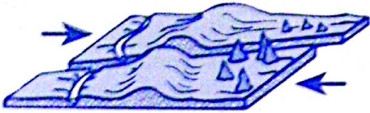
a. lateral fault
